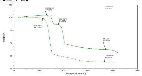
在燃燒時發生脫水反應吸收大量熱能從而降低基材的温度,釋放出的水蒸氣不僅 能稀釋火焰區反應氣體的濃度而且能吸收煙霧,達到消煙的作用。
